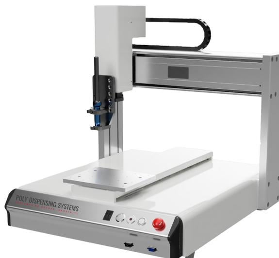
Les robots tables 3 axes de la série 782 reprennent toutes les fonctions de la série 781 mais en utilisant une technologie d'entraînement des axes avec vis à bille et servomoteur. Cela leur permet de répondre à des contraintes mécaniques plus importantes et d'embarquer sur l'axe Z jusqu'à 12kg et sur l'axe Y 15kg.
