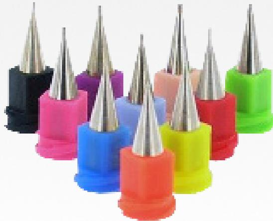
Le forme conique de ces aiguilles permet au fluide de s'écouler plus facilement, avec des pertes de charges très réduites et progressives. Il en résulte un débit plus important que sur une aiguille à canule inox pour une pression identique. Cela permet donc de travailler à des pressions beaucoup plus basses afin de « ménager » le produit.
