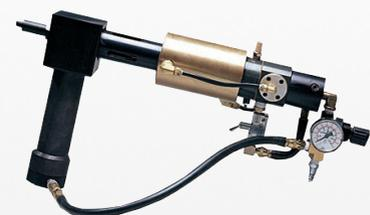
Le pistolet d'injection haute pression Semco modèle 510 permet d'injecter du mastic d'étanchéité de haute viscosité dans les zones difficiles d'accès, incluant les injections à travers de petits orifices. Il est conçu pour accepter des produits pré conditionnés dans les cartouches semco 6oz (porte cartouche 8 et 20 oz disponible en option. La pression produite est 110 fois supérieur à la pression appliquée à l'entrée. La pression nominale maximale est de 758 bars (11 000psi).
