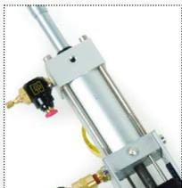
Le moteur pneumatique est équipé d'une vis micrométrique qui permet de régler facilement le volume de la dose souhaitée. La vis micrométrique est équipée d'un mécanisme de verrouillage qui permet de fixer le volume de la dose choisie
