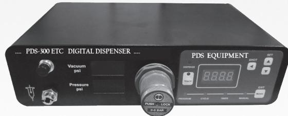
Le dosage est calibré temps/pression. Les doseurs 300ETC (digital), bénéficient d'un réglage précis du temps/pression pour obtenir un débit constant du produit et d'un réglage du temps de dépose au millième de seconde. Ils sont recommandés pour la dépose constante de produits liquides, fluides ou pâteux de toute nature, de manière répétitive et calibrée.
