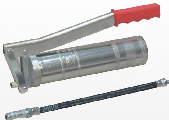
Pompe à graisse pour système à cartouches Lube-Shuttle® en acier zingué haute qualité. Poignée ergonomique, emballage carton écologique. Pression de service 400 bars, haute pression jusqu'à 800 bars. Agréments TÜV, DLG, BLT
