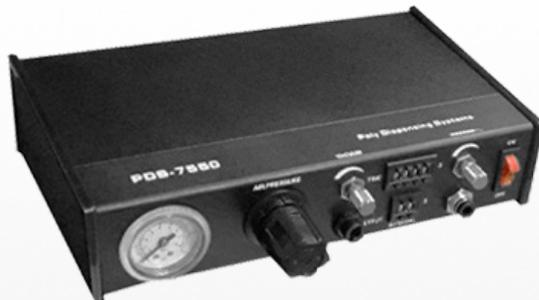
Le doseur 7550 calibré temps/pression existe en 0-1 bar et en 0-7 bar. Possédant un électrovanne MAC il permet un dosage précis de très petites quantités de produits et simultanément, celui-ci permet le positionnement de petites pièces par aspiration (à l'instar du doseur Pick Up).
