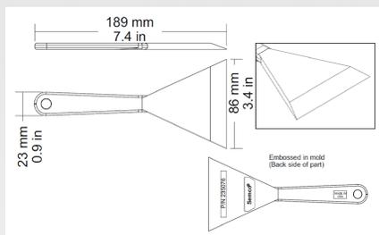
Les couteaux à joints de la gamme Semco® réalisés avec du Nylon en fibre de verre ont été spécialement conçus pour éliminer les mastics PR polymérisés et semi-polymérisés dans l'aéronautique.
